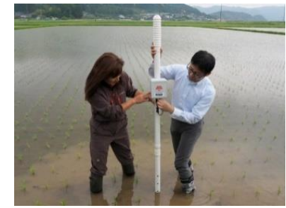
水田センサー 設置
